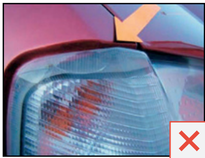
Пукнатините не са приемливи.
